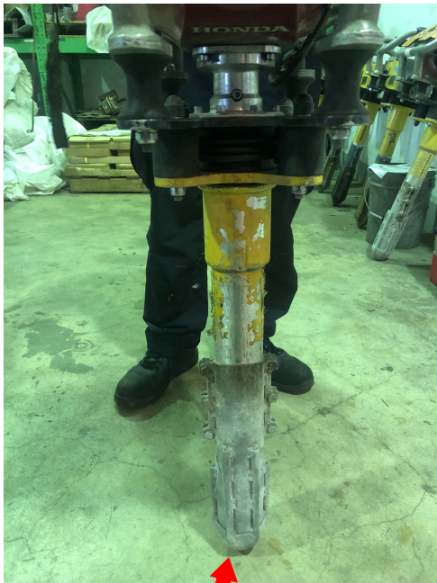
整磙機(財產編號:3050102-16-B0000003R) 砸鎬頭磨損
