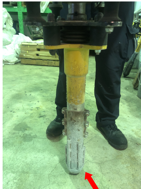
整磙機(財產編號:3050102-16-B0000004R) 砸鎬頭磨損
